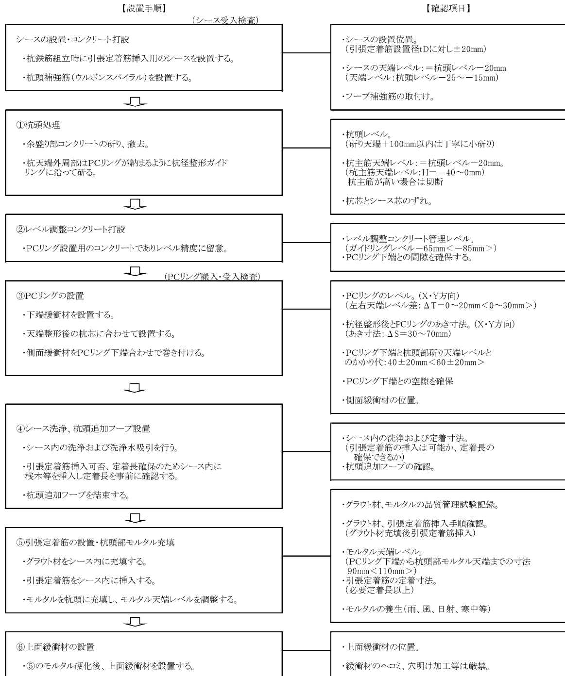
図4.1.3 P C リング及び引張定着筋の設置手順フロー (シース方式)
