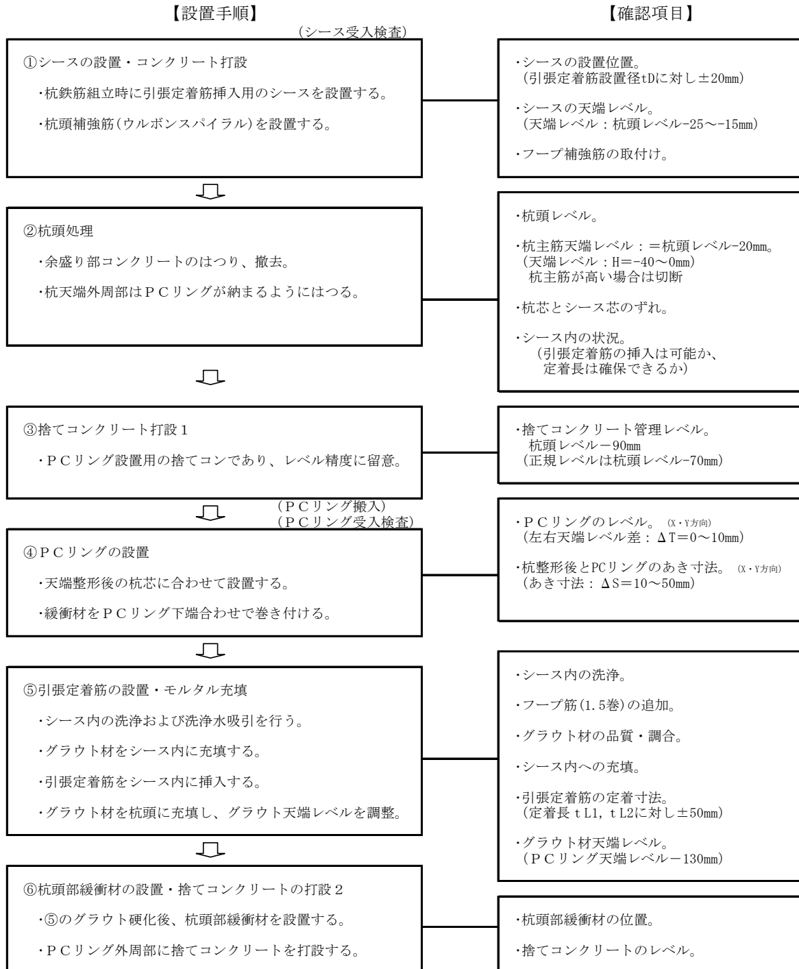
図 4.1.3 P C リング及び引張定着筋の設置手順フロー (シース方式)
