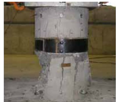
図6 No.1 試験後の破壊状況
